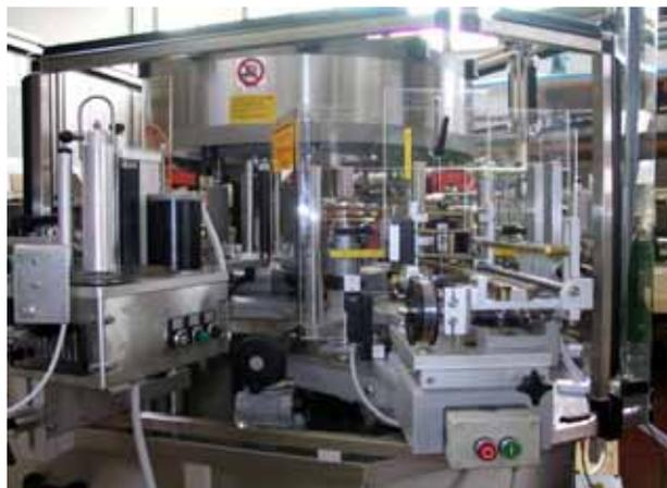
左側がタックシール、右側が糊ステーションの実例。セーフティガードも実用的で、セーフティガードの外からラベルの供給が可能。
