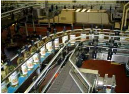
排ピンコンベアーにはR250の樹脂コンベアも装備可能で、不可能とされていた狭い場所にも十分なアキュムを確保。全てインバーター制御で通常の生産時には停止し、NG信号が出力された必要な場合のみ、コンベアーは稼働。省エネ設計です。
