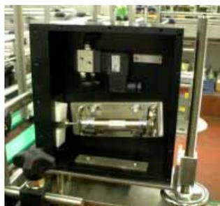
独自に開発した汎用性の高い排ピンプッシャーを装備し、調整・メンテナンスも容易で、エア駆動のピストンを使用。ラベラー内のシーケンサーで作動も管理して、小型で軽量ながら確実な作動を保証します。
