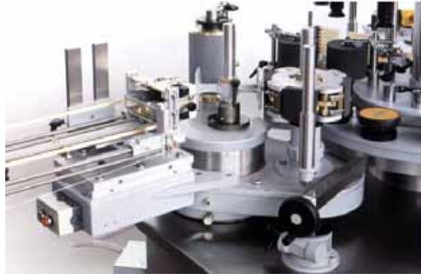
糊パレットのシャフトは1本で、独特な糊パレットの動きとなり、マガジンからのラベルの取り出しはほぼ直線運動。ラベル切れを極力排除します。
