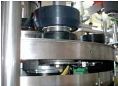
山洋電機製のステップモーターを使用。ベルトドライブでピンテーブルを駆動。自在な回転パターンを実現します。
